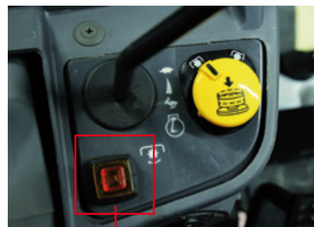
Külön kapcsolható lágy-felfutás funkció a kardántengelyekhez. A rendszer a TG 5000-es sorozatból származik és egyedülálló ebben a kategóriában.
