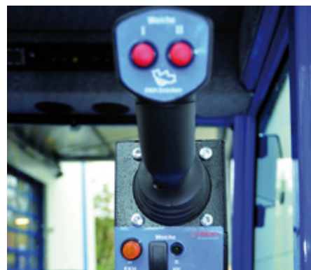
Opció: lehajtható kartámasz multifunkcionális elektro-hidraulikus vezérléssel - egy kézzel vezérelhető.
