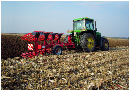
ASTER 120 függesztett váltvaforgató eke
