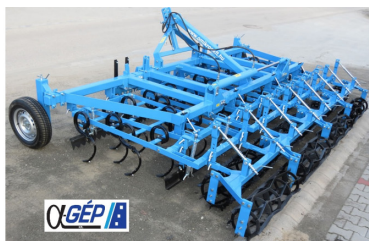
KÉSZLETES KOMBINÁTOR OSK-4,4H (4+2) FÜGG. MAGÁGYKÉSZÍTŐ HIDR. ERŐGÉP IGÉNY: 100 - 120 LE SÚLY: 1600 kg ÁR: 2.750.000,-Ft + áfa Érd.: SZABÓ DÁVID 30/ 415-31-21
