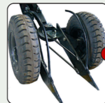
B. Szárvezetők A két első szárvezető felemeli az eldőlő szárat és felállítja a növényt, ezzel könnyebbé teszi a kiszedést.
