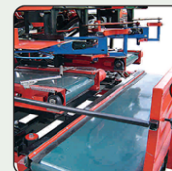
F. Kihordó szalag A hátsó kihordó szalag, folyamatosan, illetve a működtető személyzet igényének megfelelően lehelyezi a fokhagymacsomókat a földre, a fokhagymafejek védve maradnak a szár által. A szalag alacsony elhelyezkedése megakadályozza a fejek sérülését, ütődését.
