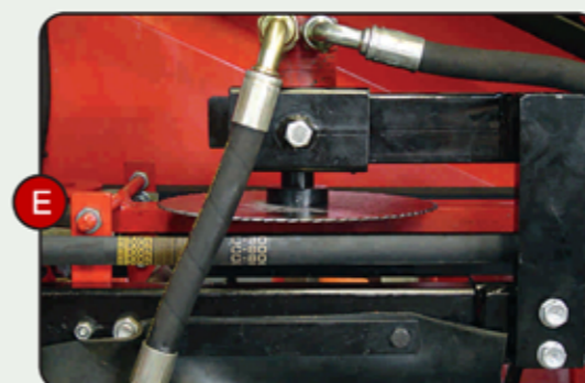
E. Vágó tárcsa Egy (gyorsabban forgó) csipkézelt tárcsa levágja a szárat (a magasság szabályozható), és elhelyezi a fokhagymafejeket a szalagra.
