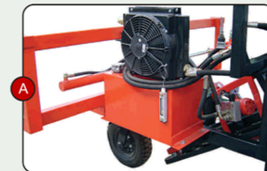
A. Hidraulikus meghajtás. Hidraulikusan meghajtott motorok működtetik a betakarító gép egységeit.
