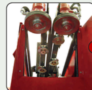
D. Szállító és tisztító szalag A szállító szalagon - melyet hidraulikus motor működtet - egy rezgő rendszer segítségével eltávolításra kerül a föld egy része.
