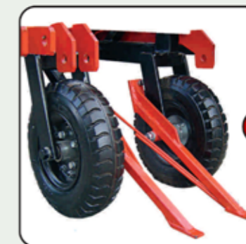
B. Szárvezetők A két első szárvezető felemeli az eldölt szárat és felállítja a növényt, ezzel könnyebbé teszi a kiszedést. A szárvezetőket hidraulikusan vezérli a működtető.
