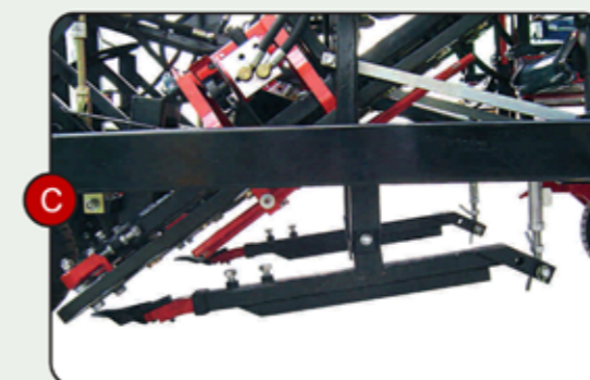
C. Gyökérvágó kés A kés elvágja a gyökérzetet, majd a fokhagyma óvatosan kiemelődik, hogy a szalag összeszedje. A kések helyzete és mélysége állítható
