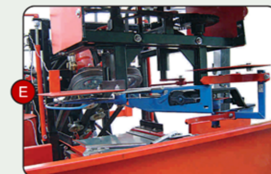
E. Kötöző egység A gép elkészíti a fokhagymacsomókat (a kötés magassága, a szalag feszessége és a csomók mérete állítható). A csomókat a száron köti meg, így lehetővé teszi a könnyebb felszedést és későbbi feldolgozást.
