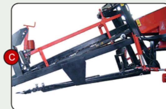
C. Gyökérvágó kés A kés elvágja a gyökérzetet, majd a fokhagyma óvatosan kiemelődik, hogy a szalag összeszedje. A kések helyzete és mélysége hidraulikusan állítható.
