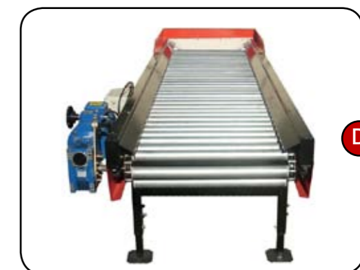
D. Az asztal hossza és a 33 görgő a tökéletes tisztítást biztosítják és lehetővé teszik akár 5 fő munkavégzését, a termény válogatásához.
