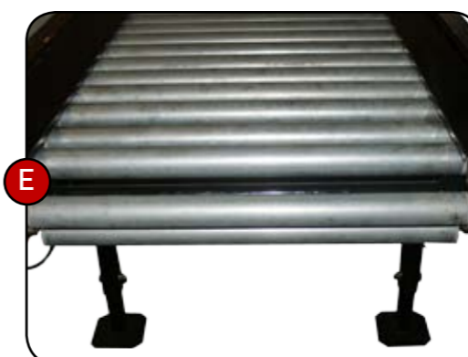
E. A munkaszélesség 670 mm, mely nagy mennyiségű munkavégzést tesz lehetővé, (akár 8.000 kg/óra)
