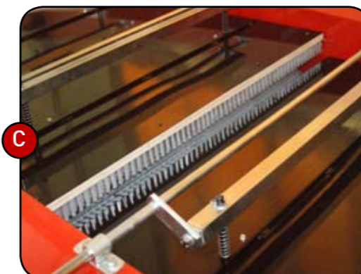
C. Felső kefesor állíthatóságának köszönhetően a tisztítás intenzitása szabályozható.
