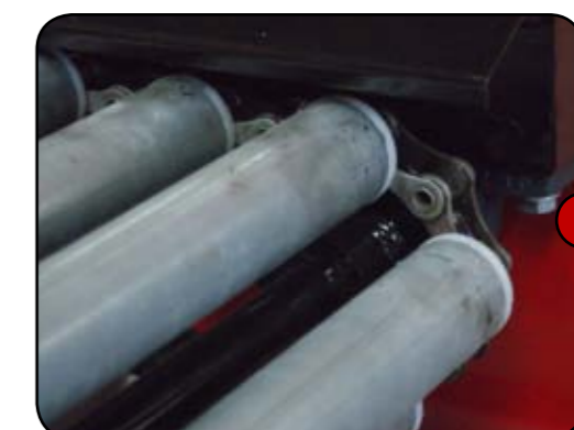
F. A görgők átmérője a fokhagyma fejek folyamatos forgatását biztosítja, így teszi lehetővé tisztításukat.
