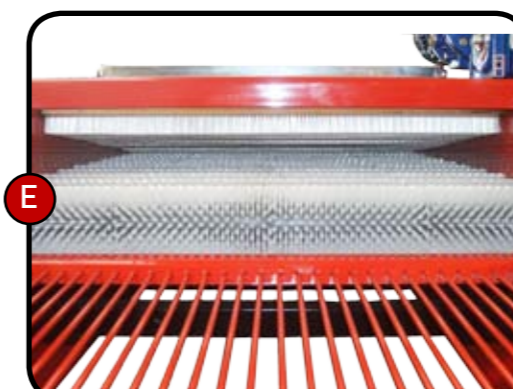
E. A fokhagymára való, speciális szintetikus szálak lehetővé teszik a hagymák kiváló forgását és tökéletes tisztítást biztosítanak, a termék sérülése nélkül.
