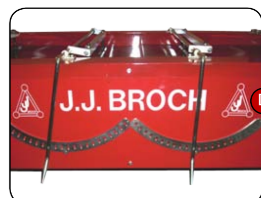
D. A felső kefesor a karok segítségével könnyen állítható.
