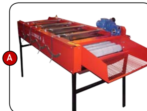
A. 3 méteres alsó és felső kefék területnek köszönhetően a föld és külső héjak eltávolítása nagyon hatékony.
