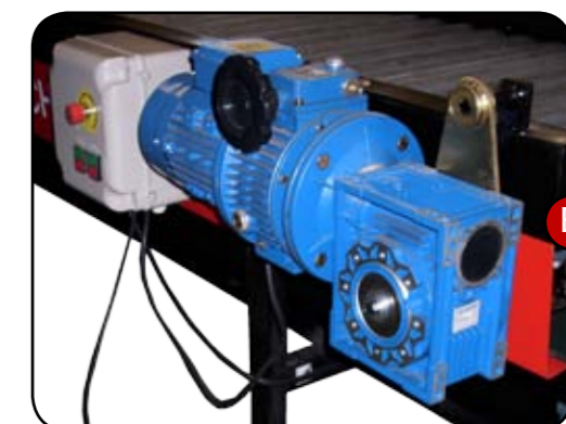
B. A görgőket egy 0,75 KW-s elektromos motor hajtja, a sebesség állítható.
