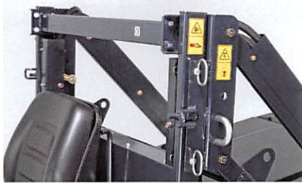
Szennyezéstől és ütközéstől védett hidraulikavezetékek.
