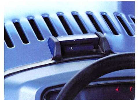
Könnyű karbantartás: a motorháztető és az oldalsó burkolat egy fogantyúval gyorsan és egyszerűen felnyitható. Nyitott motorháztetőnél az ISEKI-biztonsági kapcsoló leállítja a motort.
