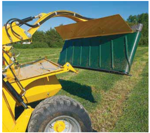
Az ELHO Arrow 3700 vontatott kasza önmagában is egy hatékony gép, de ez még növelhető a gyártó Side Flow oldalkihordójával. A szalag saját hidraulikával rendelkezik.
