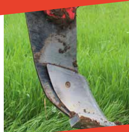
Oldalra hajlított, 30 mm vastag kések
