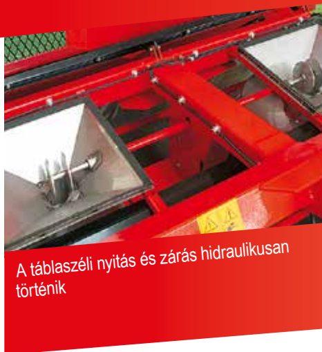
Határszórási lehetőség mechanikus határolóval
