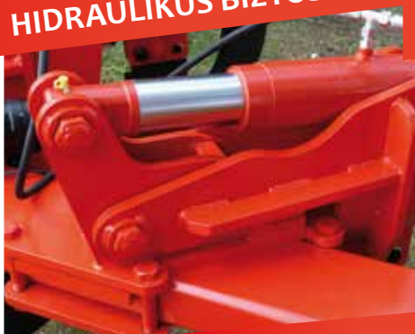
Hidraulikus Non-Stop biztosítás
