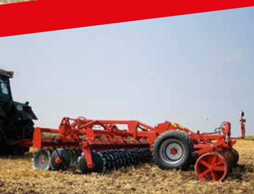
A szállítókerékek a tárcsaszekció és a henger között helyezkednek el
