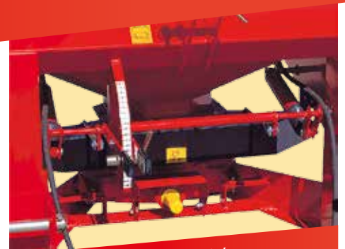
A kiömlőnyílás nyitása és zárása mechanikusan történik. Hajtómű biztonsági kioldással.
