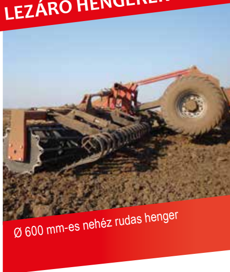
Elöl csipkézett, hátul sima vagy kivánság esetén fordítva vagy vegyesen
