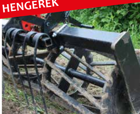
Alaphelyzetben Ø 500 mm-es „Z” henger
