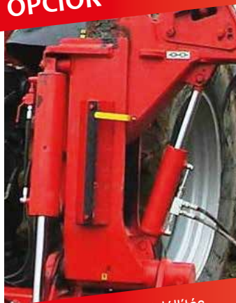
Hidraulikus első ekefejállítás
