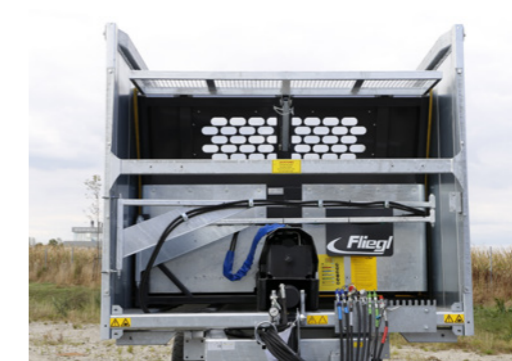
Masszív, korrektül megvezetett letolórendszer – nincs gyorsan kopó alkatrész
