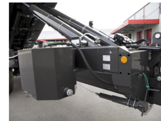
60 literes (opcionálisan 90 l) fedélzeti hidraulika, kardánmeghajtás hidraulikaszivattyúval és olajtartállyal
