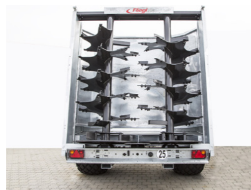
Erős szórórendszer kb. 12 m-es munkaszélességgel
