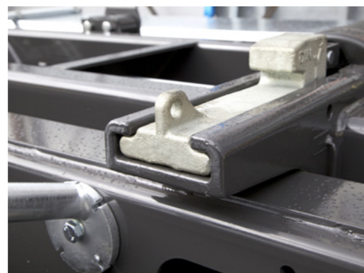
Áthelyezhető zárszerkezet a külső és belső rögzítéshez.
