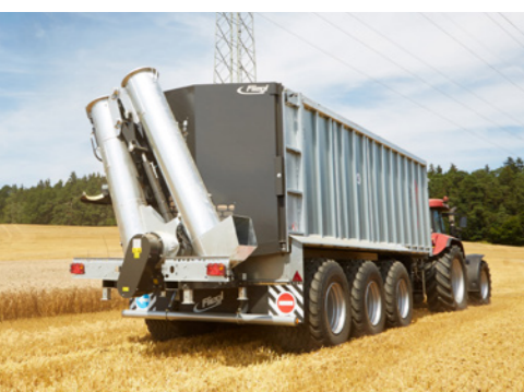
Átrakócsiga Ø 400 mm-rel Hidraulikusan csukható
