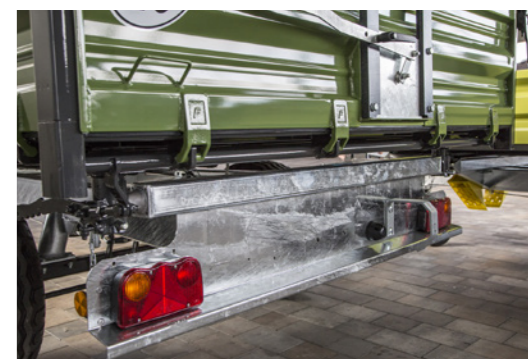
Hátsó központi zár EDK 40-es típustól alapfelszereltség
