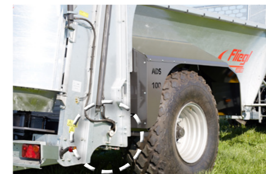
Mechanikus letolásszabályozással alap kivitelben. Opció: tolásszabályozás elektromos potencióméterrel
