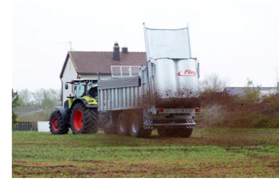
»Profi V2« szórószerkezet zárt széles szóró hátfallal, kb. 18–27 m szórási szélességgel
