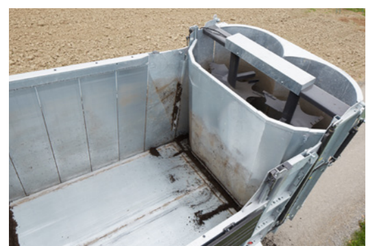
A teljesen horganyzott zsilip sorozatkivitelben felszerelve.
