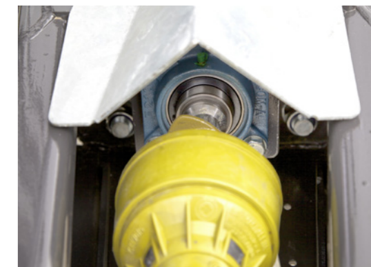
60 literes (opcionálisan 90 l) fedélzeti hidraulika, kardánmeghajtás hidraulikaszivattyúval és olajtartállyal
