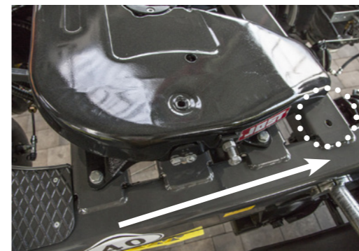
Mechanikus pótkocsiplató-állítás egytengelyes és tandem utánfutó esetén
