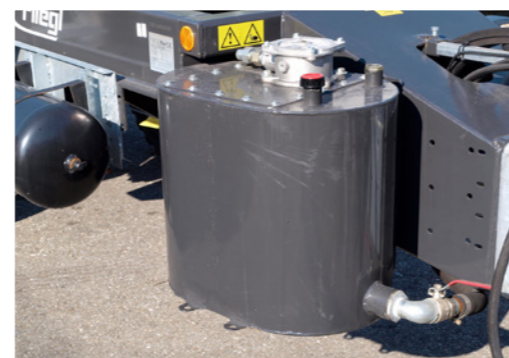
Fedélzeti hidraulika kardánhajtású hidraulika szivattyúval
