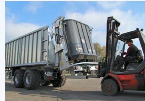
A szórószerkezet egy targoncával 20 percen belül egyszerűen felszerelhető.
