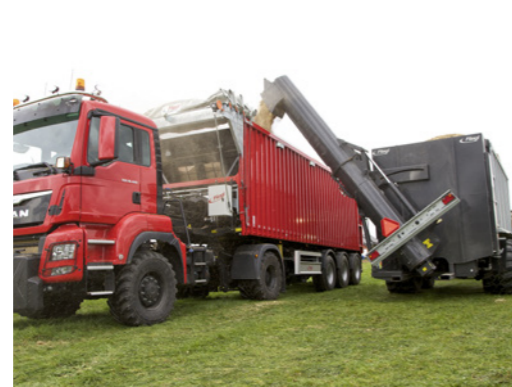
Fent: búza áttöltése 400-as átrakó csiga segítségével Lent: faapríték átadása 600-as átrakó csiga segítségével
