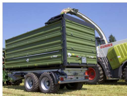
Hidraulikus hátfal integrált oldalfalakkal
