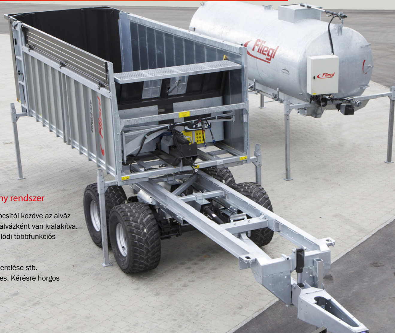
Hidraulikus munkahenger a felépítmény emeléshez
