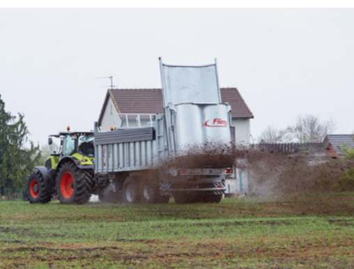
Fent: szilárd trágya szórása Profi szórószerszeggel – nyitott hátfal Lent: fermentációs szubsztrátum szórása Profi V2 szórószerszeggel - zárt hátfal
