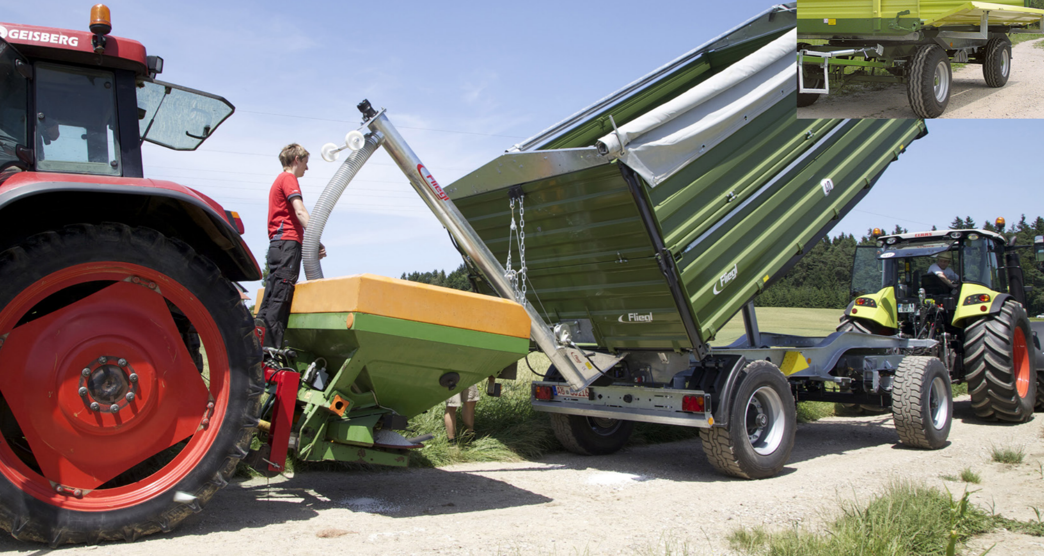
Átrakócsiga - 150 mm átmérőjű, 3.000 mm/4000 mm hosszúságú, horganyzott vagy korracélból készített amely, könnyen felszerelhető, csörlővel rögzíthető.
