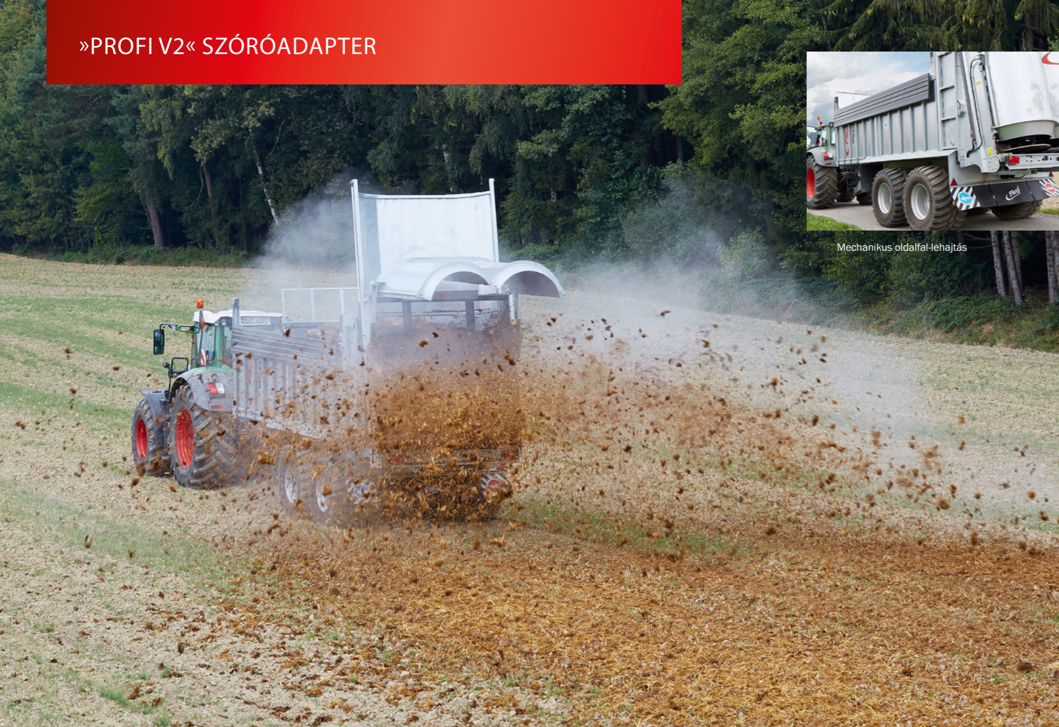
»Profi V2« szórószerkezet zárt széles szóró hátfallal, kb. 18–27 m szórási szélességgel
