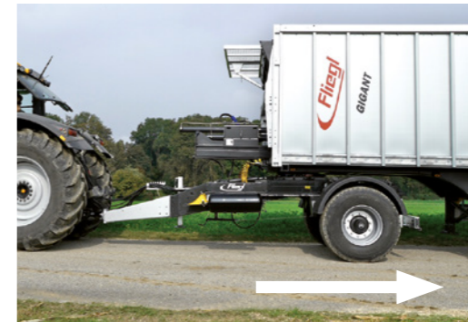
Mechanikus nyeregszerkezet állítás egytengelyes és tandem Dolly esetén
