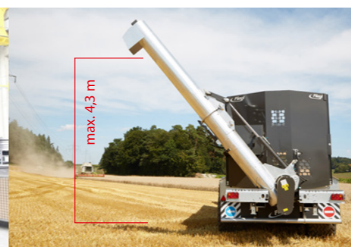
4,30 m átrakómagasság (gumizástól függően)
