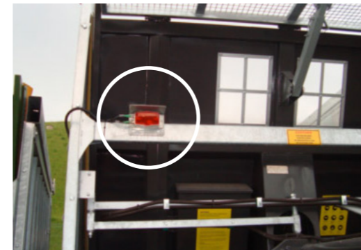
Figyelmeztető lámpa (a hátsó ajtó zárását jelzi)
