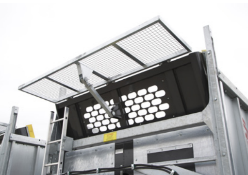
Rácsos homlokfal magasító: Alapkitelben mechanikusan, opcióban pedig hidraulikusan állítható
