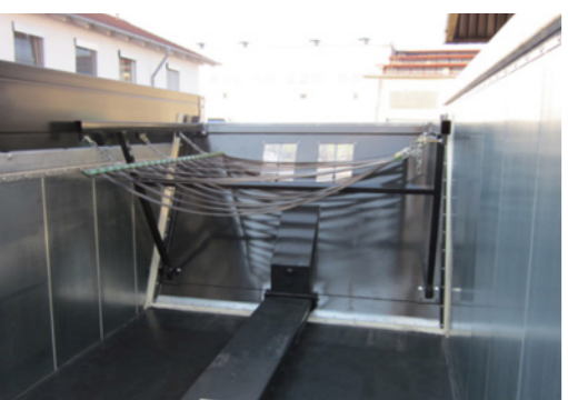
A esésgátló megakadályozza a betakarított burgonya lehullás közbeni sérülését
