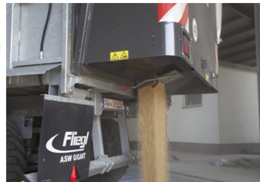
Nagy térfogatú hidraulikus hátsó ajtó gabonakieresztő ablakkal
