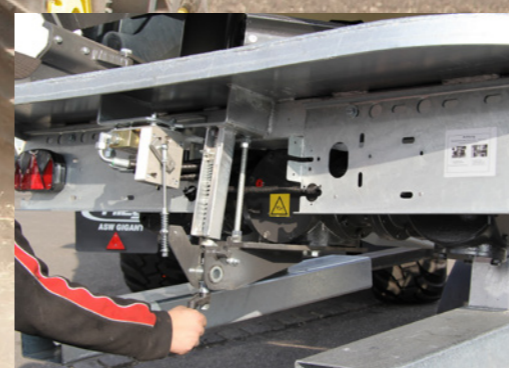
Az automatikus tolásszabályozással a tolási sebesség magától beállításra kerül
