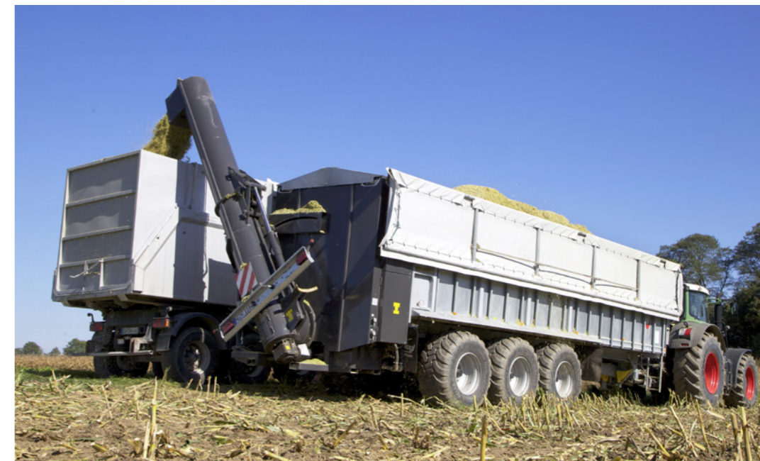
Átrakási teljesítmény pl. kukoricasiló esetén akár 14 m 3 /perc.
