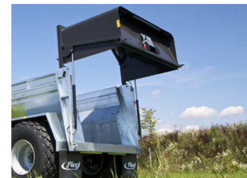
Az ADS opcionálisan 800 mm-es nagy hátfallal felszerelhető és szállító pótkocsiként használható
