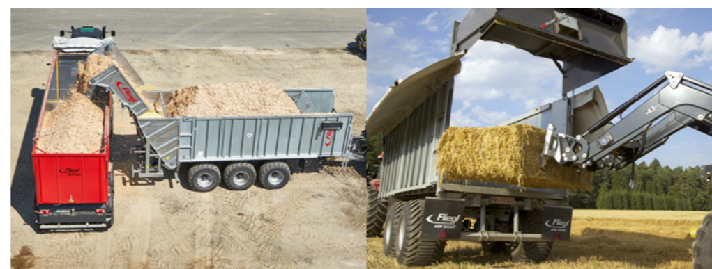
Fent: »PomOver« burgonya áttöltő szalag Lent: fű vagy faapríték áttöltése »MobilFast«-áttöltő szalaggal
