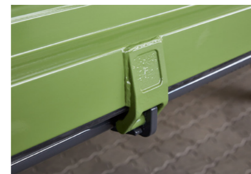
Oldalsó központi zár, EDK 60-as típustól alapfelszereltség. 4500 mm plató hosszúságtól 6 ponton zár, ezáltal a plató profil sehol nincs kivágva.
