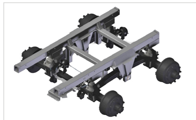
Titan tandem futómű a legjobb talajkiegyenlítésért, nem igényel karbantartást.
