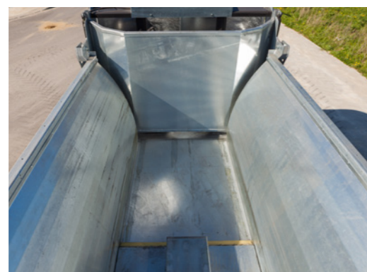
A hidraulikus letolórendszernek köszönhetően kisebb kopás - nem láncos lehordó
