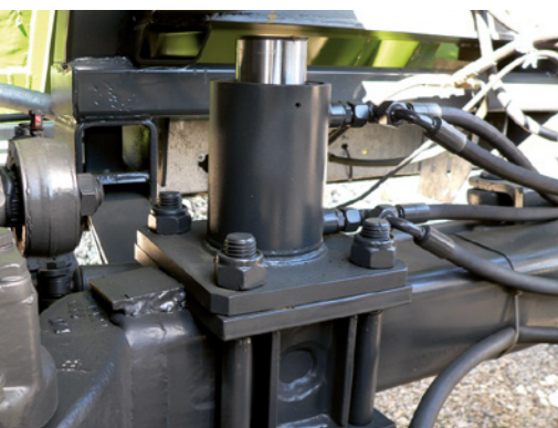
Opcionális: hidraulikus támasztás a tengelynél
