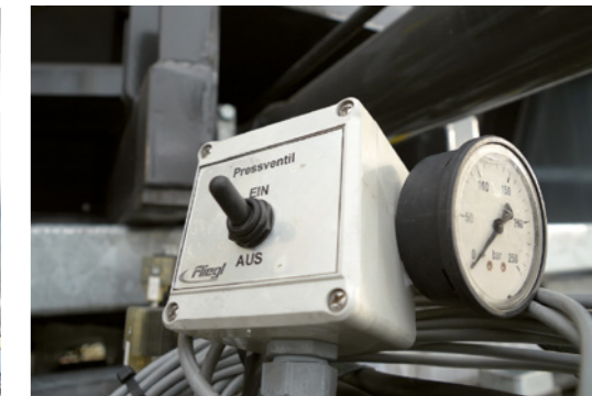
Tömörítőszelvény: automatikus préselés nyomásszabályozó a rakomány tömörítésére pl.: fűsiló, lucernasiló
