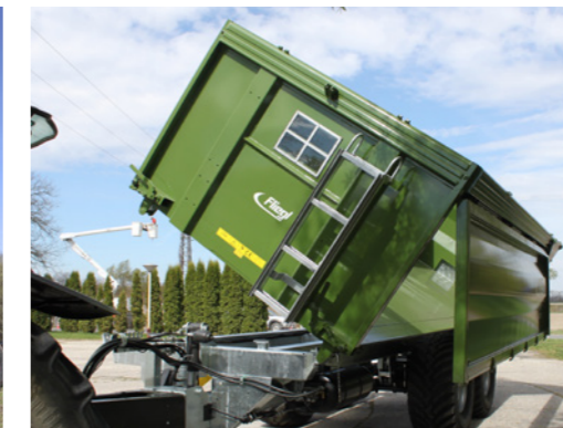
Tandem három oldalra billentő teknős pótkocsi Rendkívül robusztus az erősített oldalfalaknak köszönhetően
