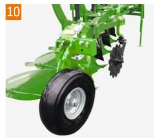
Kerék-Ø 550 mm légtömlesztés x 160 mm szélesség
