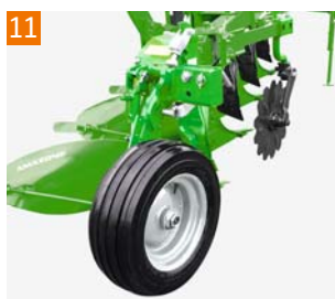
Kerék-Ø 600 mm légtömlesztés x 220 mm szélesség A következőkhöz áll rendelkezésre: M/XM/XMS/XS (6-vasú, valamint 5-vasú S- és/vagy V-ekékhez nem)
