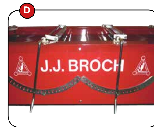
D. A felső kefesor a karok segítségével könnyen állítható
