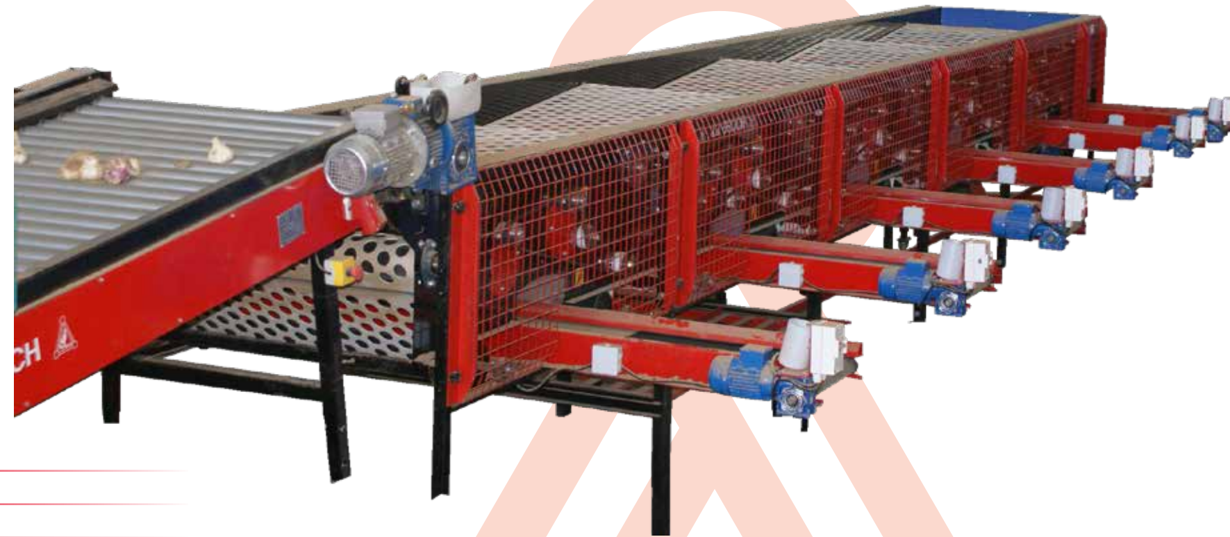
A. Moduláris kialakítás. A moduláris kialakítás lehetővé teszi a tetszés szerinti egységek összekapcsolását.
