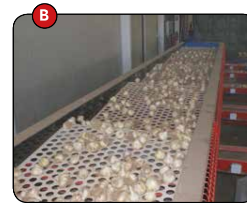
B. Precíz osztályozás. A modulok hossza, valamint a sebesség állíthatósága lehetővé teszi a megfelelő osztályozást.
