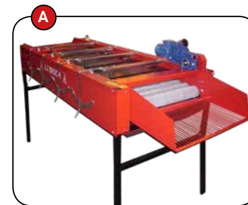
A. A 3m-es alsó és felső kefék tisztító, amely hatékonyan tisztítja földet és a külső barna réteget.
