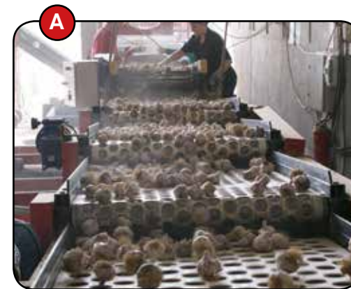
A. Moduláris kialakítás. A moduláris kialakítás lehetővé teszi a tetszés szerinti egységek összekapcsolását.
