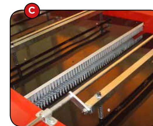
C. Kettős szabályozással ellátott 2 felső kefe, amely szabályozza a tisztítási erőt.
