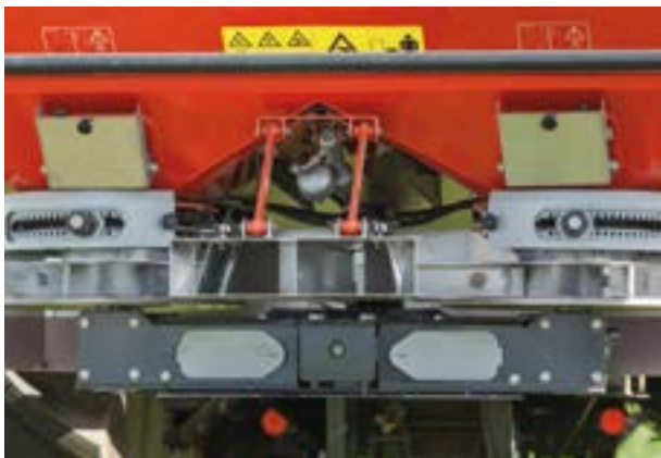
Egyoldali határszórás – szórás a határvonalról a határszóró lemezzel
