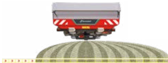
10 méterrel csökkentett szórás szélesség a bal oldalon
