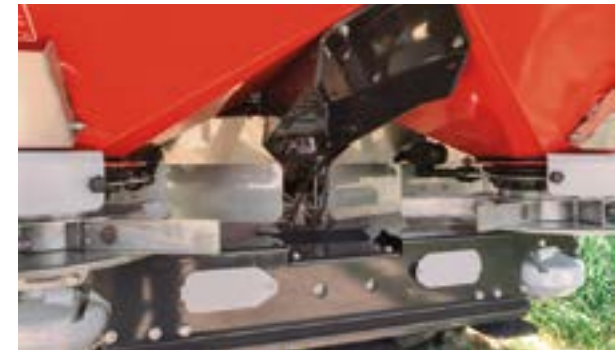
Elektromos működtetésű rendszer a kijuttatási mennyiség szabályozására
