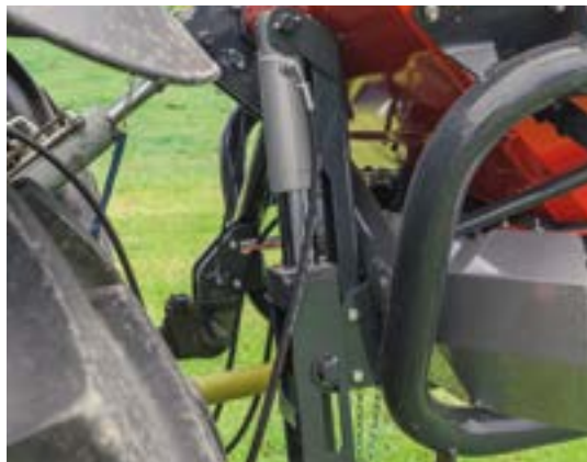
Határszórás billentőhengerral – szórás a határvonal irányába a szélső művelőútról
