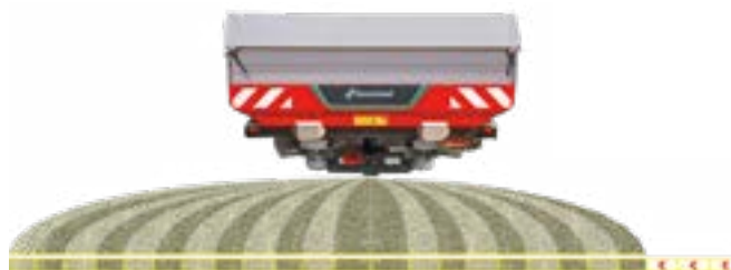
6 méterrel csökkentett szórás szélesség a jobb oldalon
