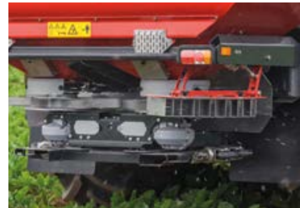
Határszórás – határszórás az ExactLine rendszerrel
