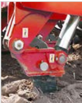
Pro-Fit lazítókések hidraulikus auto- reset késbiztosítással is elérhetőek DTX modellén.
