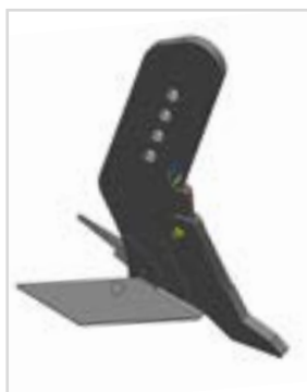
Az LD lazítókések munka közben nem bolygatja a talajfelszínt. A talaj közvetlenül a kés mögött összezárul.
